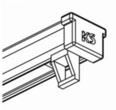
**Rail complet avec rouleaux, embouts et supports de plafond
